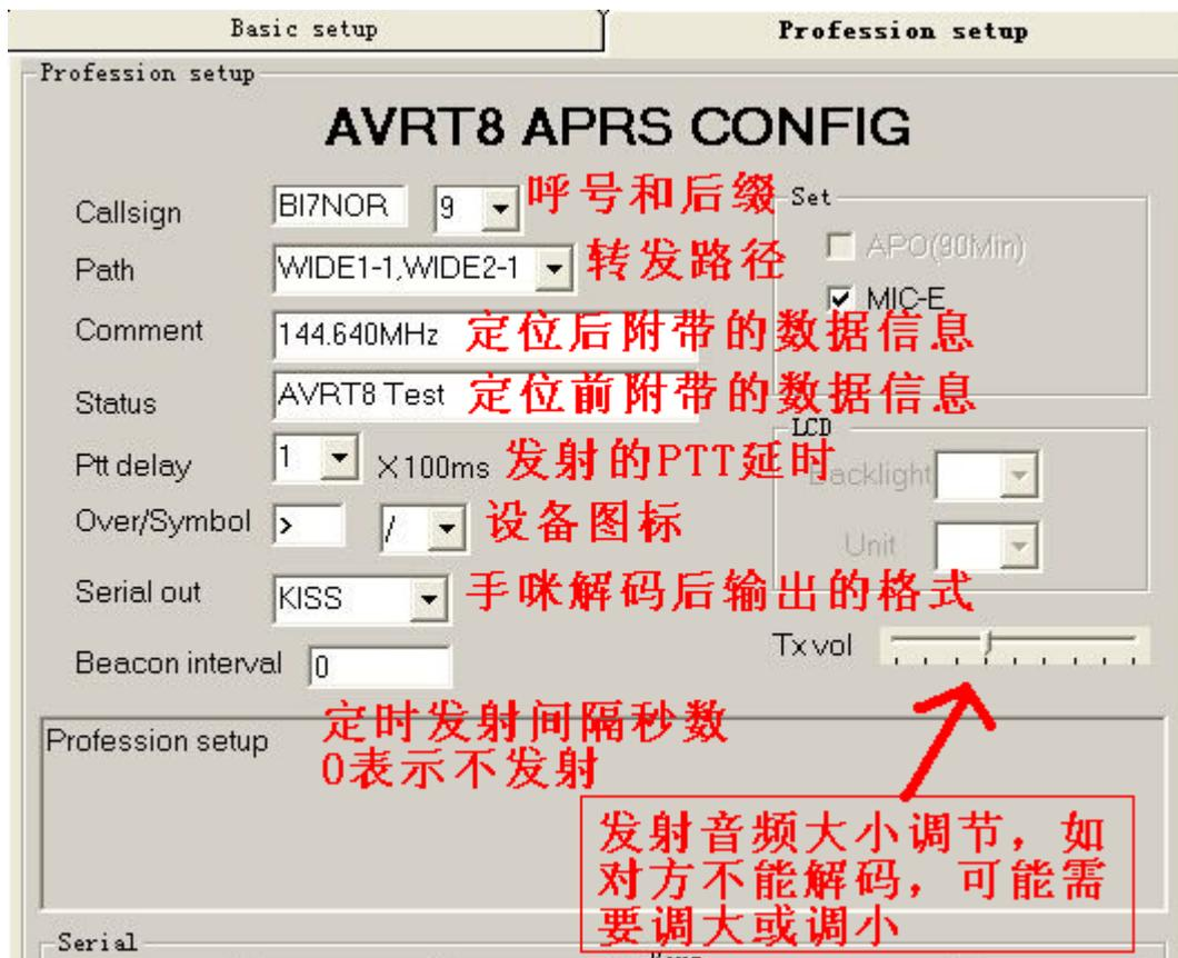
手咪解码输出的格式： 默认 KISS，适合连手机，平板，电脑
