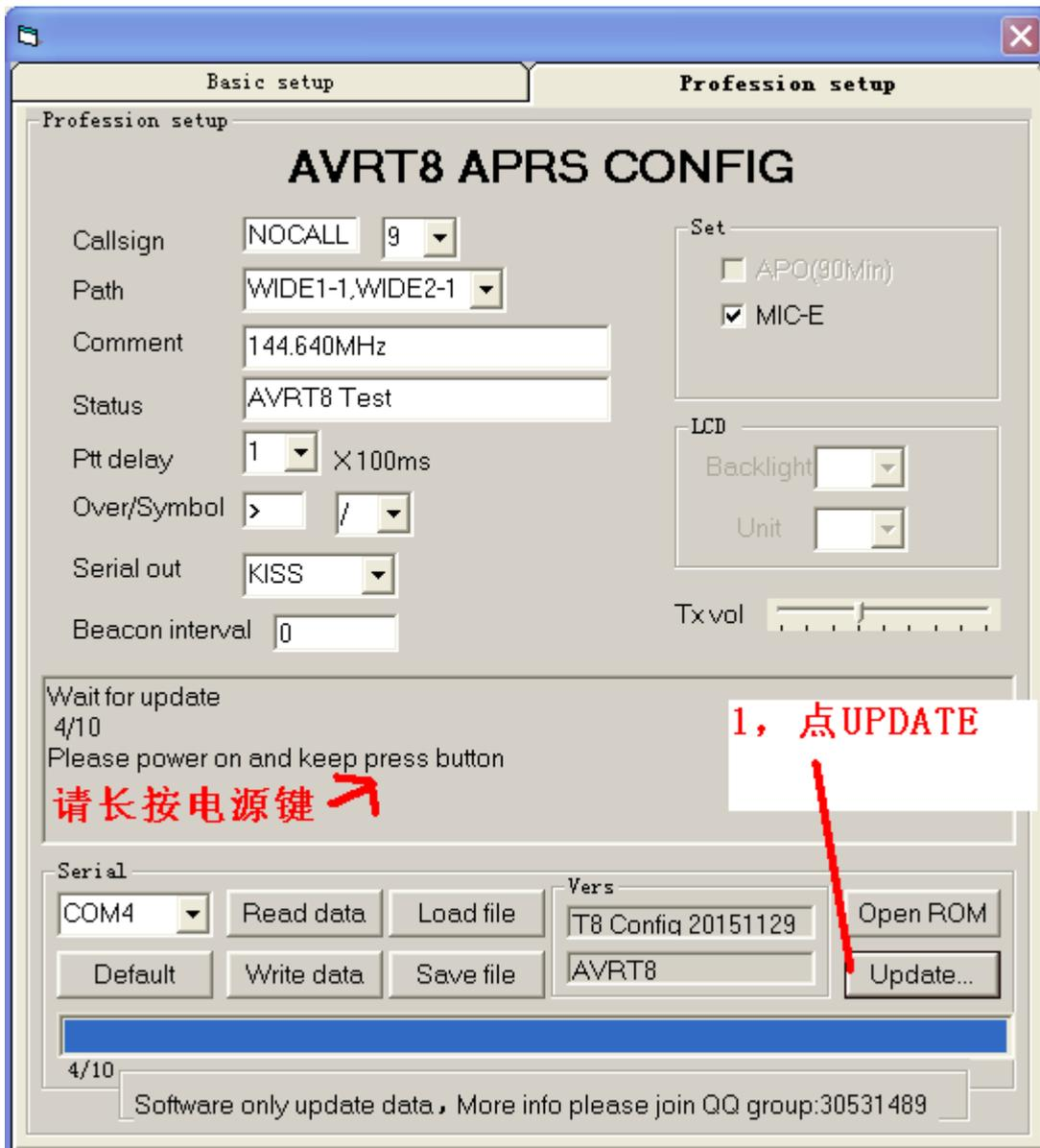
直至提示：请长按电源键。此时立即长按开关机键。直至最下面蓝条从左到右显示百分百
